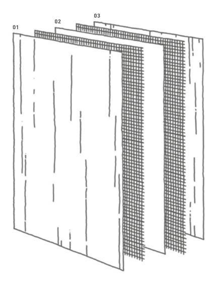
01 CERAMIC LAYER 6mm 02 SOLID LAYER 03 CERAMIC LAYER 6mm
